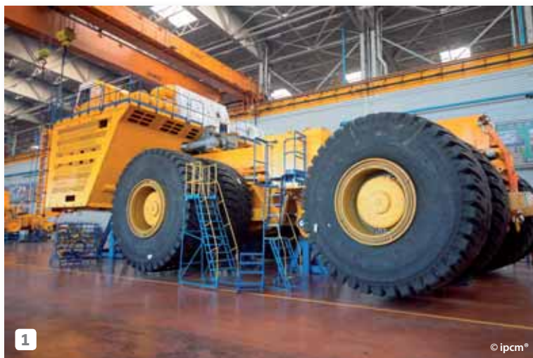
1 The BelAZ GVW 75710 during assembly. Il BelAZ GVW 75710 in fase di assemblaggio.
