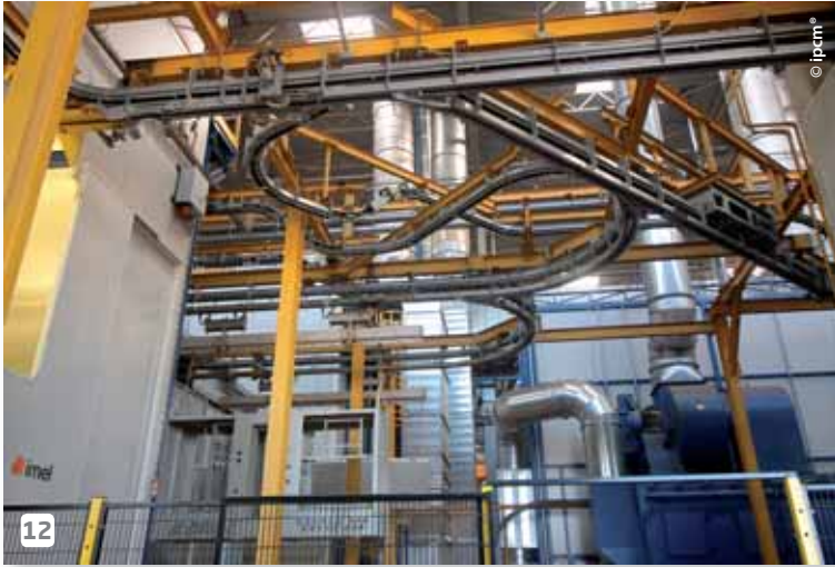
The Power & Free conveyor. Il trasportatore birotaia.
