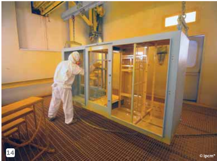
The primer application booth. Cabina applicazione primer.
