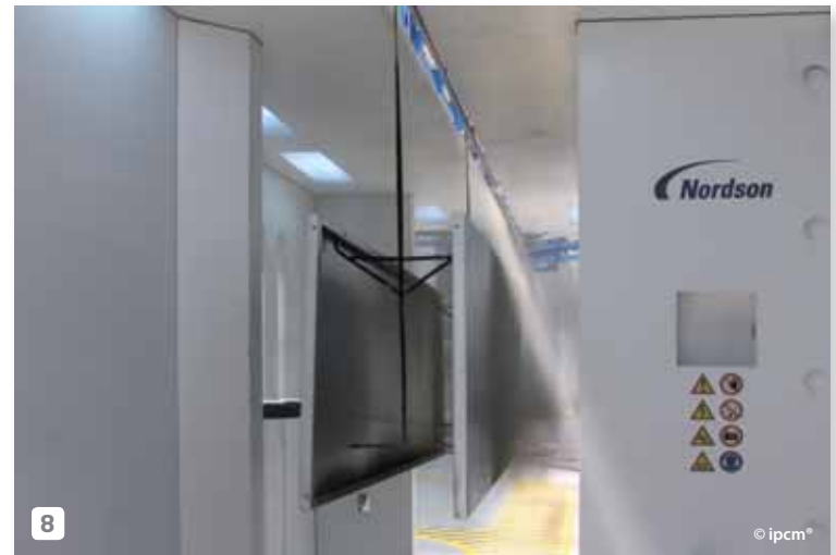
8 Aplicación del recubrimiento en polvo con las pistolas Encore HD de Nordson. Aplicação do revestimento em pó com as pistolas Encore HD de Nordson.
