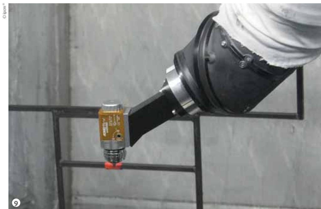
Figura 9: Un dettaglio dell'applicazione della vernice con pistola pneumatica DeVilbiss.
