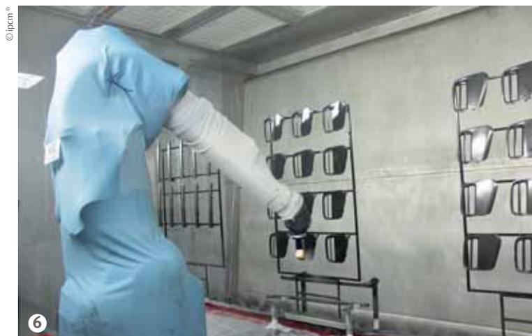
Figura 6: Cabina di applicazione *primer*.
