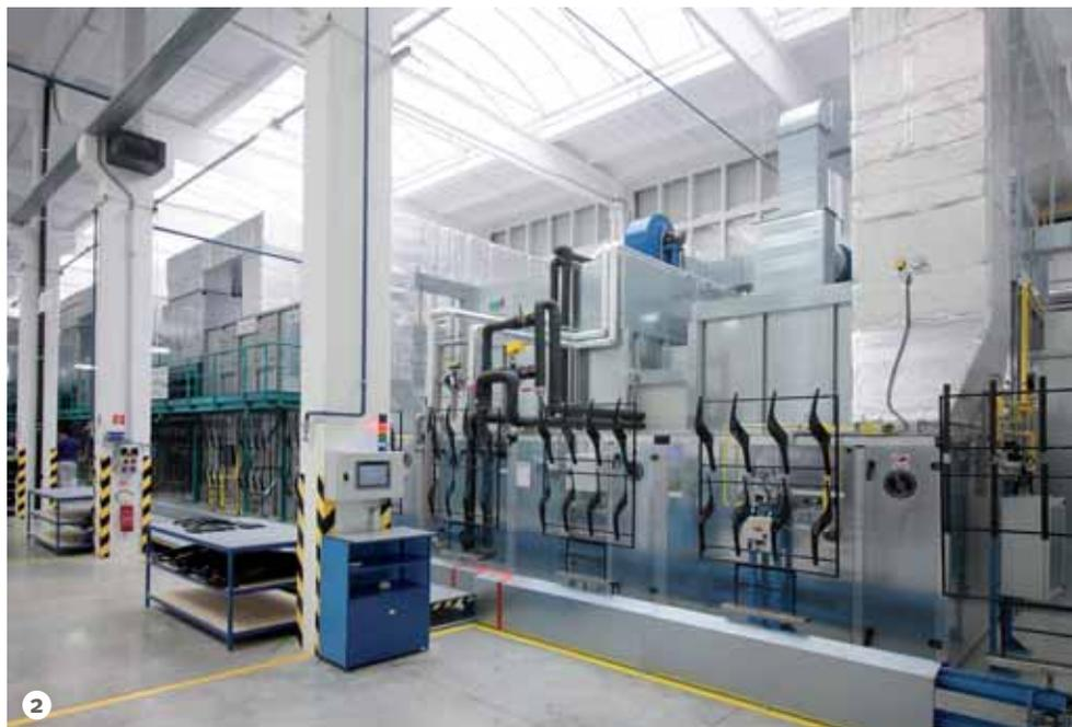
Figura 2: Panoramica dell'impianto di verniciatura.
