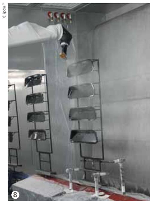
Figura 8: Cabina di applicazione trasparente finale.
