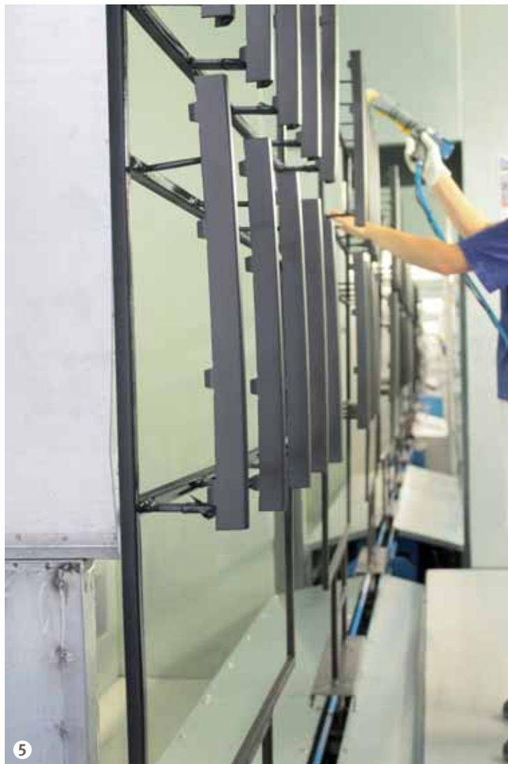
Figura 5: La stazione di ionizzazione dei pezzi.
