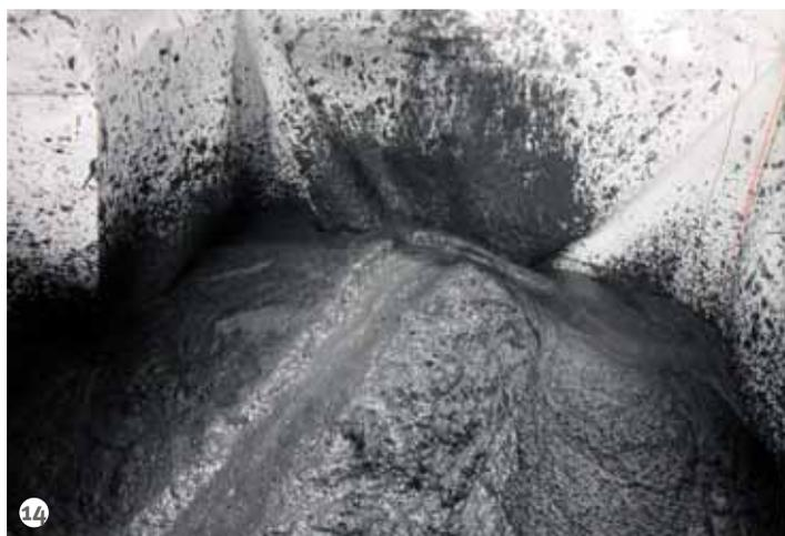
Figura 14: I fanghi di risulta, con umidità minore del 40%, sono convogliati direttamente nei *big bag* per lo smaltimento successivo.
