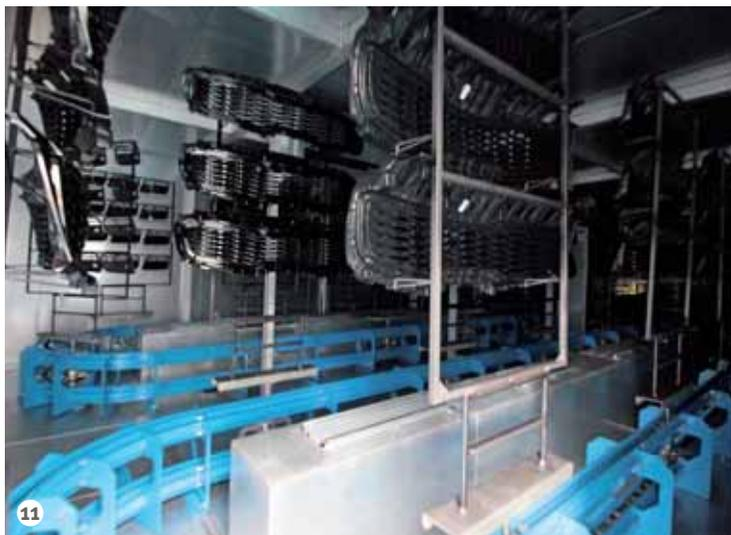
Figura 11: Interno del forno di cottura a campana.
