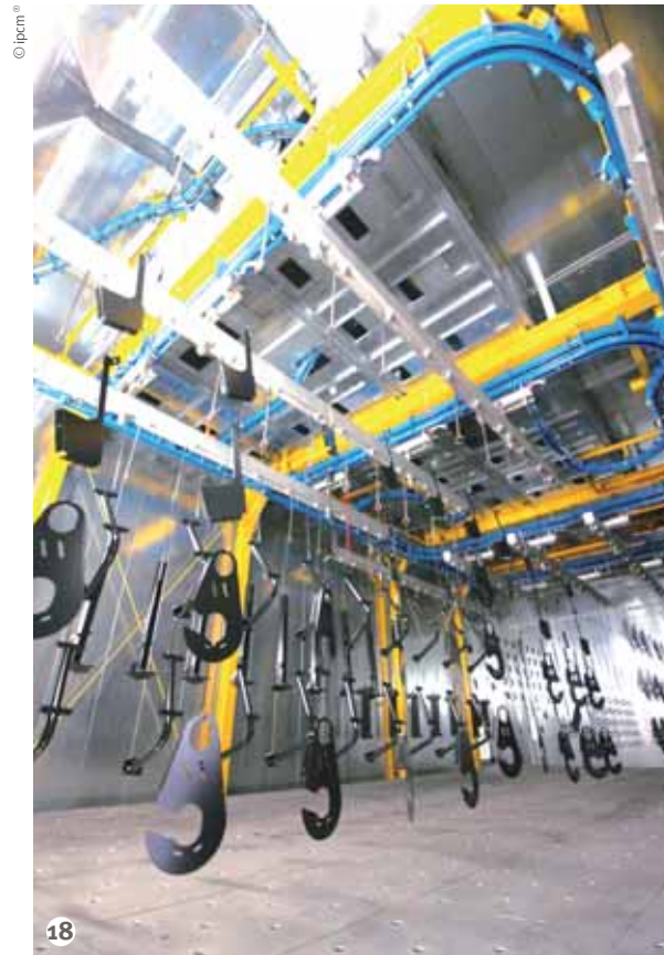
Figura 18: La zona di raffreddamento dei manufatti trattati.
