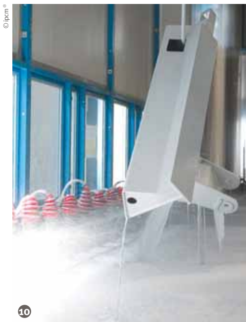
Figura 10: La vasca di cataforesi e, sullo sfondo, le celle di dialisi.
