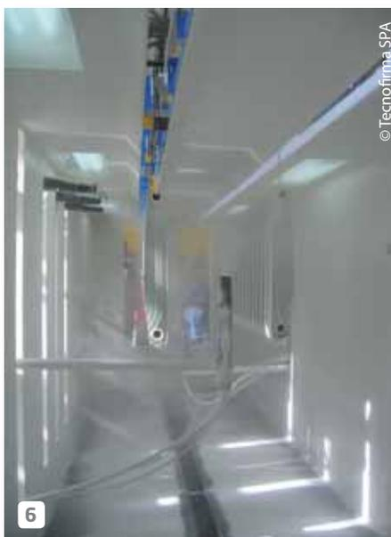
*lavaggio post-anaforesi. Anche in questo caso il processo avviene per immersione con rampe finali di ultrafiltrato puro.*
