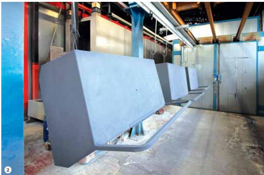
**Figura 2: L'impianto statico affianca l'impianto in linea ed è in grado di trattare manufatti di grandi dimensioni.**
